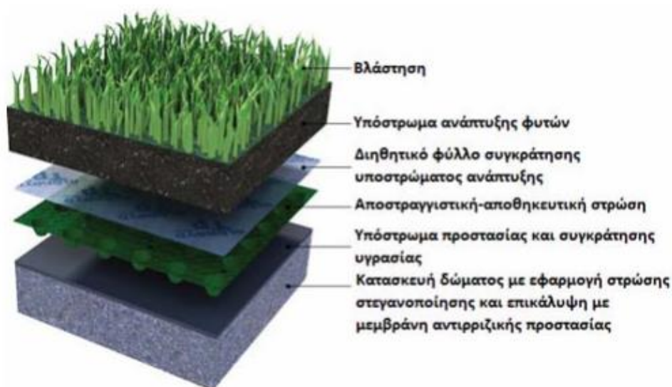
Εικόνα 6-1:Τυπική Υποδομή Φυτεμένου Δώματος/ Στέγης
